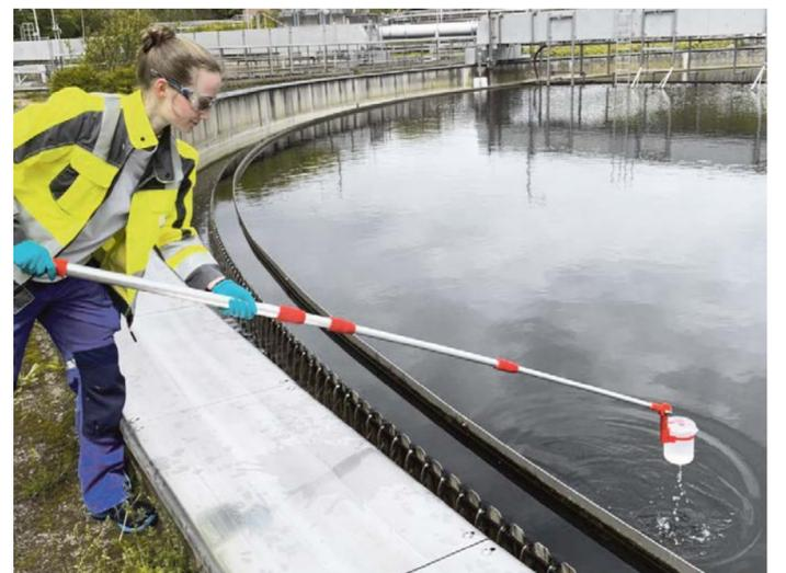
Das neue Inline-Messverfahren soll stichprobenartige, manuelle Probenahmen wie hier in der Kläranlage Aachen-Soers des Wasserverbandes Eifel-Rur ergänzen und in vielen Fällen ersetzen. Bild: © WVER
